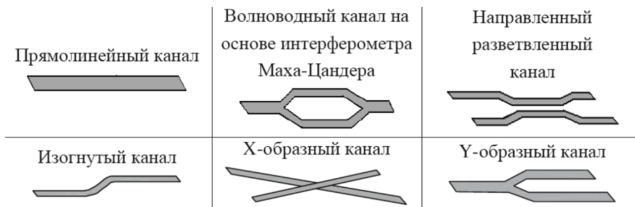
Рис.2. Основные виды направляющих структур интегральной фотоники (С. Воробьев и др., Вычислительная фотоника, 2012)
