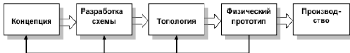
Рис. 1 Проверка на ЭМС, базирующаяся на физическом прототипе
