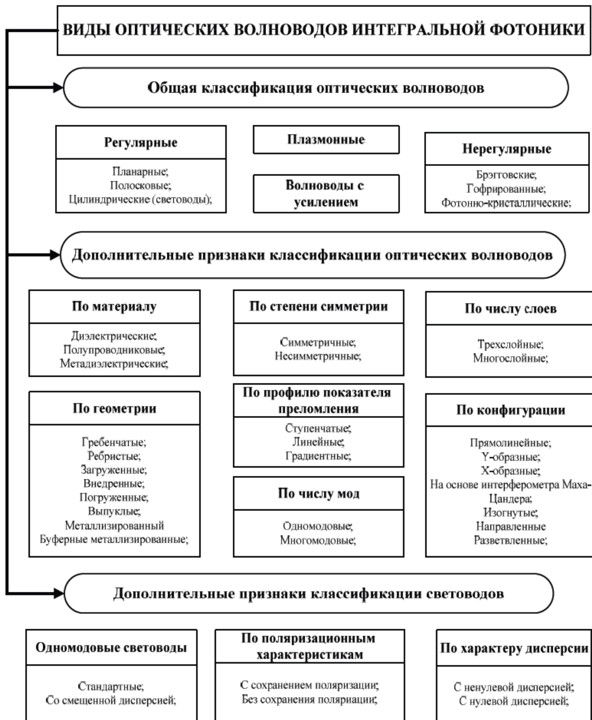
Рис.1. Основные виды оптических волнопроводов (С. Воробьев и др., Вычислительная фотоника, 2012)
